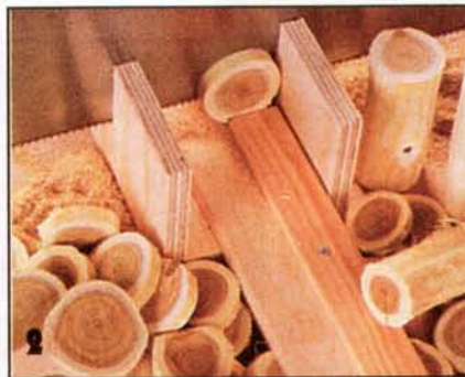
2 Ошкуренные ветви нарезают на диски толщиной 10 мм. Лучшие инструменты для этого — стусло с упором, обеспечивающим одинаковую толщину дисков, и обычная мелкозубая ножовка.
