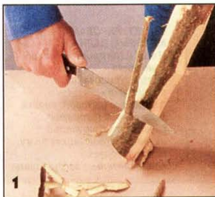
1 С заготовленных ветвей (сучьев) удаляют кору. Для этого подойдёт острый кухонный нож.
